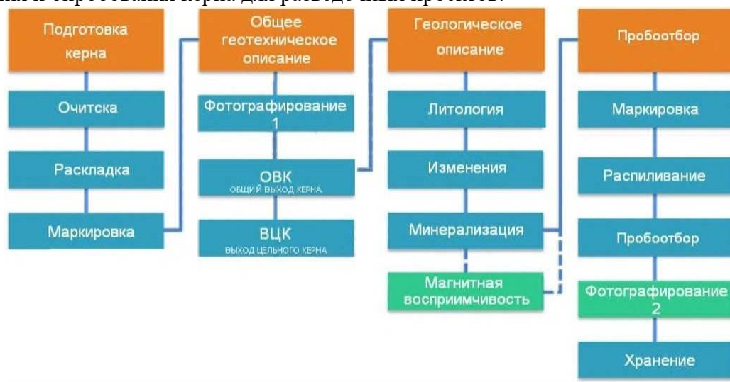
Рис. 1.11 Технологическая схема документации и обработки керна Геотехническое документирование производится прямо на буровой («в
