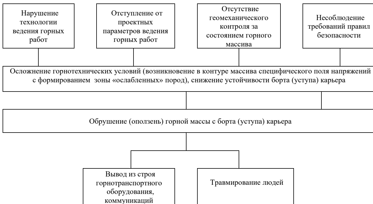
Рис.5.1 - Блок-схема вероятного сценария аварии при обрушении (оползней) горной массы с борта (уступа) карьера
