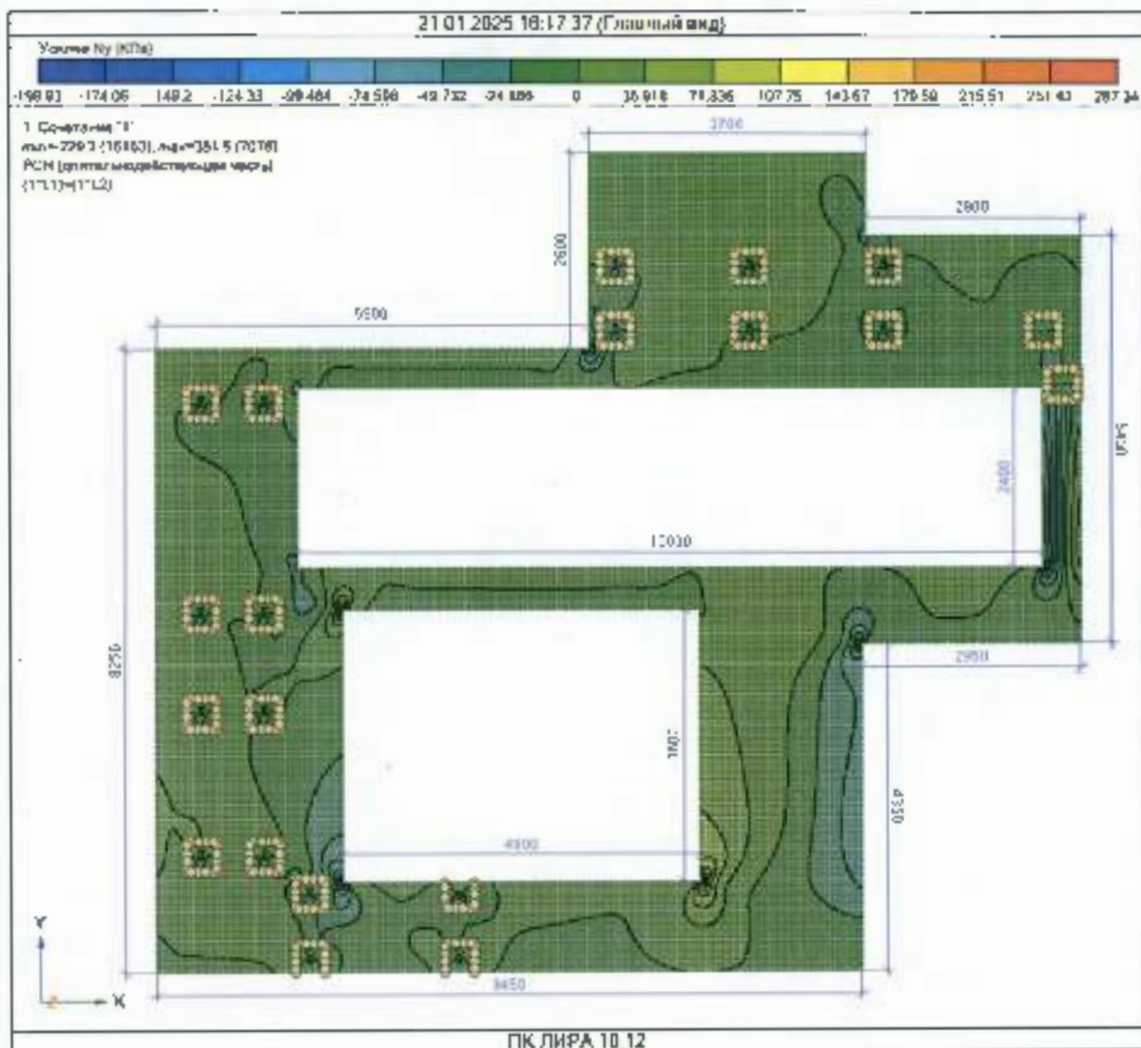
Рис. 6. Эпюры усилий N_y в элементах Сочетания 1.
