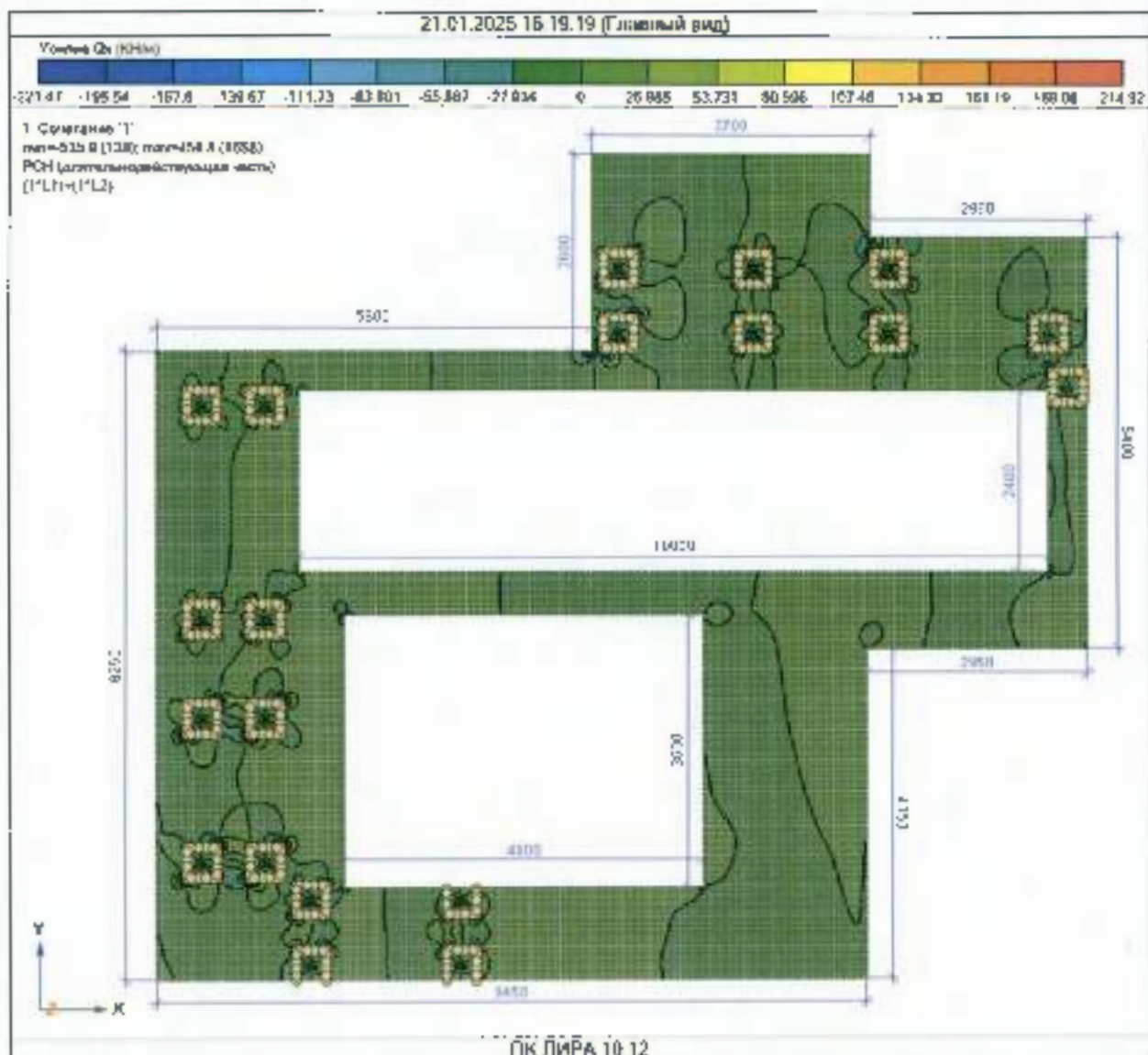
Рис. 9. Эпюры усилий Q_x в элементах Сочетания 1.
