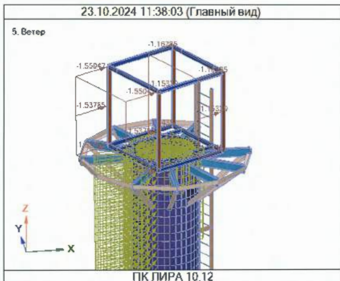
Рис. 14. Нагрузка ветровая приложенная на всю площадь пескоуловителя.
