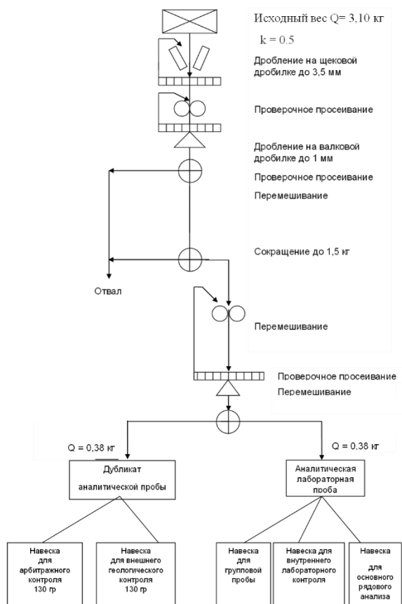
Рис. 4.6 - Схема обработки керновых проб
