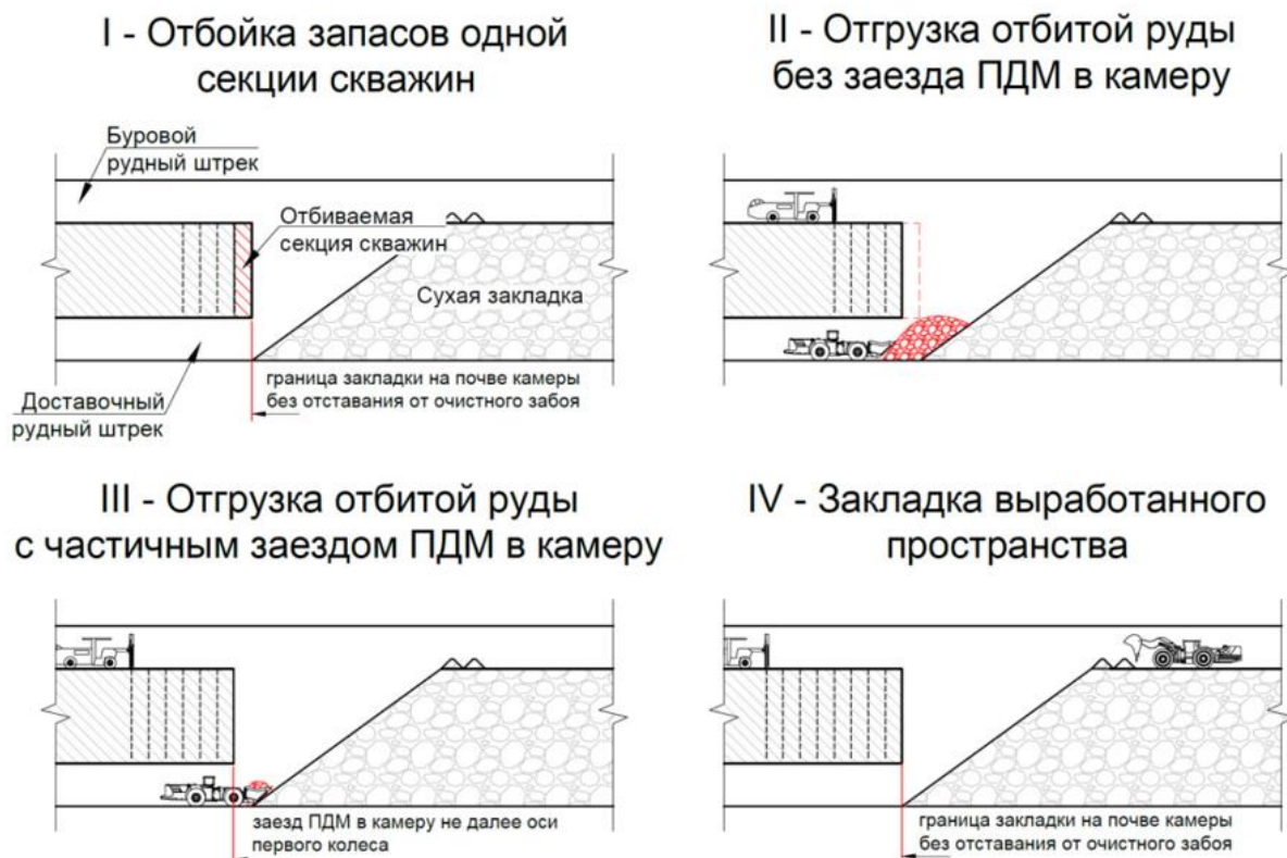
Рисунок Е.3 – Принципиальная схема организации работ при использовании ПДМ без режима ДУ
