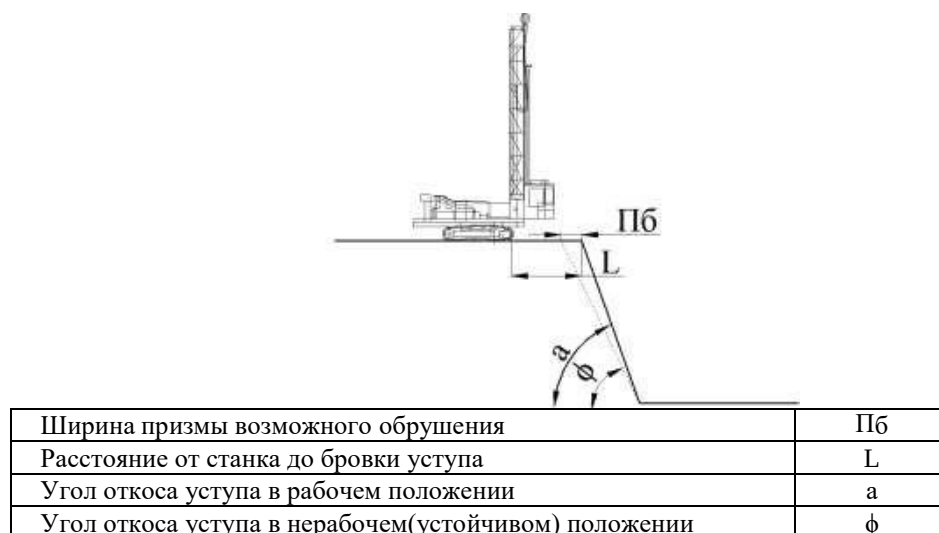
Рис. 6. Размещение бурового станка на уступе
