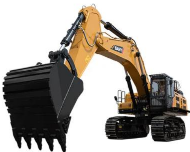
Рис. 3.5– Экскаватор Sany SY750H
