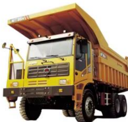
Рис. 3.6– SDLG MT86 (60 тонн)
