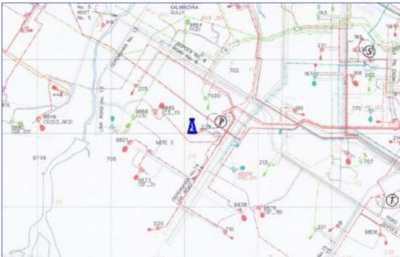
Рисунок 3.2 – Карта-схема расположения проектируемого горизонтального бокового ствола 239-1 в скважине 239
