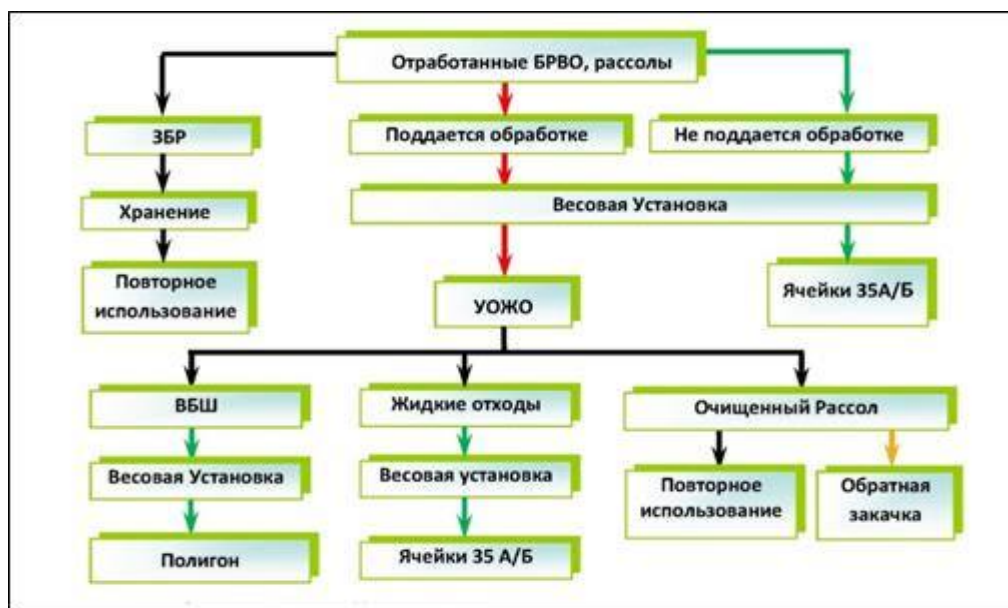
Схема 2. Переработка отработанных ВБР и рассолов на установках КУО и захоронение ВБШ на Полигоне, жидких отходов в ячейках 35 А/Б
