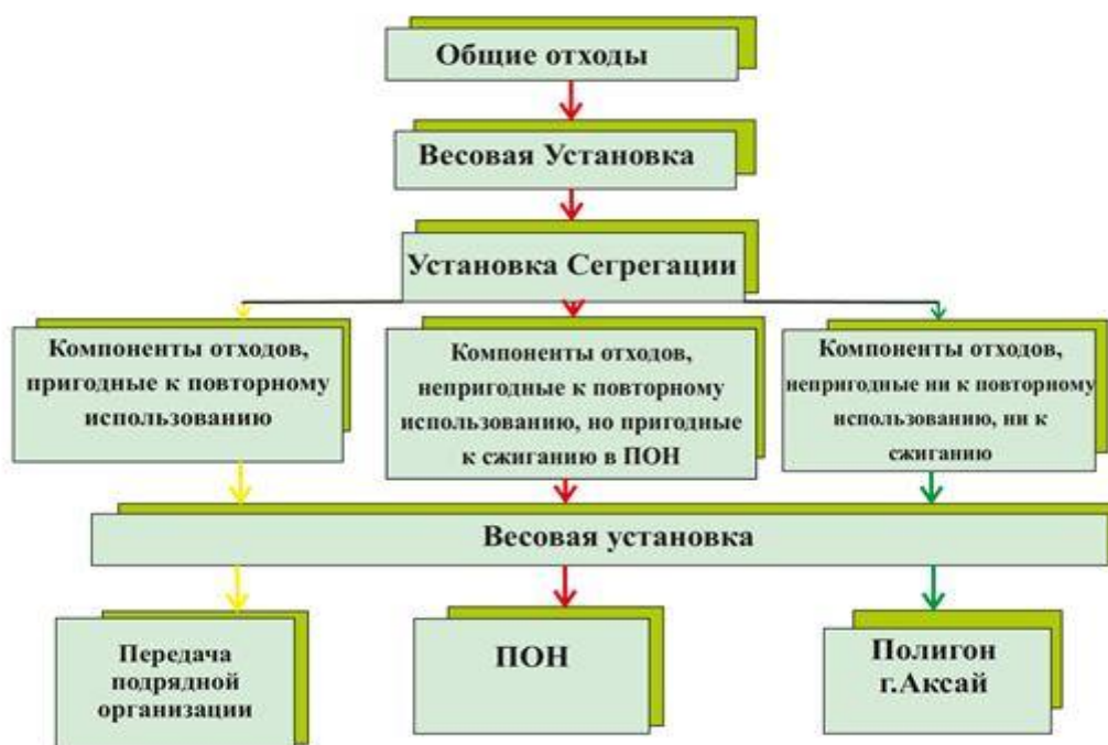
Схема 8. Разделение отходов на Установке сегрегации отходов на 3 потока (компоненты отходов, пригодные к повторному использованию; непригодные к повторному использованию, но пригодные к сжиганию в ПОН; непригодные ни к повторному использованию, ни к сжиганию)
