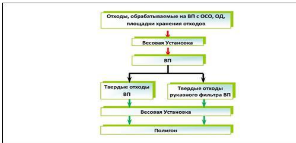
Схема 6. Переработка отходов во ВП и размещение отходов после термической обработки ВП и с рукавного фильтра ВП на Полигоне
