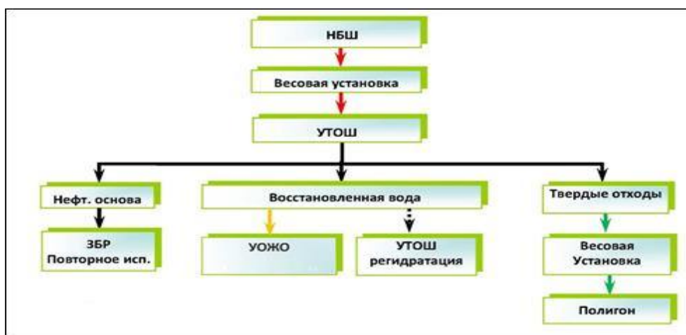
Схема 4. Переработка бурового шлама на нефтяной основе на УТОШ
