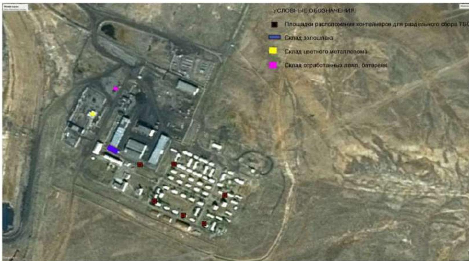
Рисунок 1.8 – Схема расположения площадок сбора и временного накопления отходов в вахтовом поселке и промплощадке №1 – «Участок Центральный».
