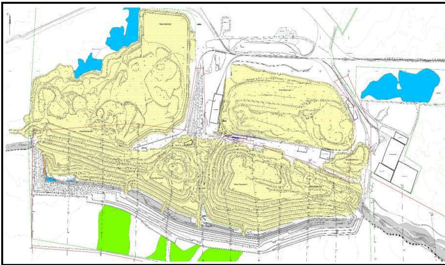
Рисунок 1.5 – Схема участка Центральный. Расположение внешних отвалов и карьера.
