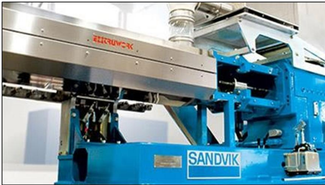
Фото 2.1 Установка грануляции по технологии «Ротоформ» компании «Сандвик»
