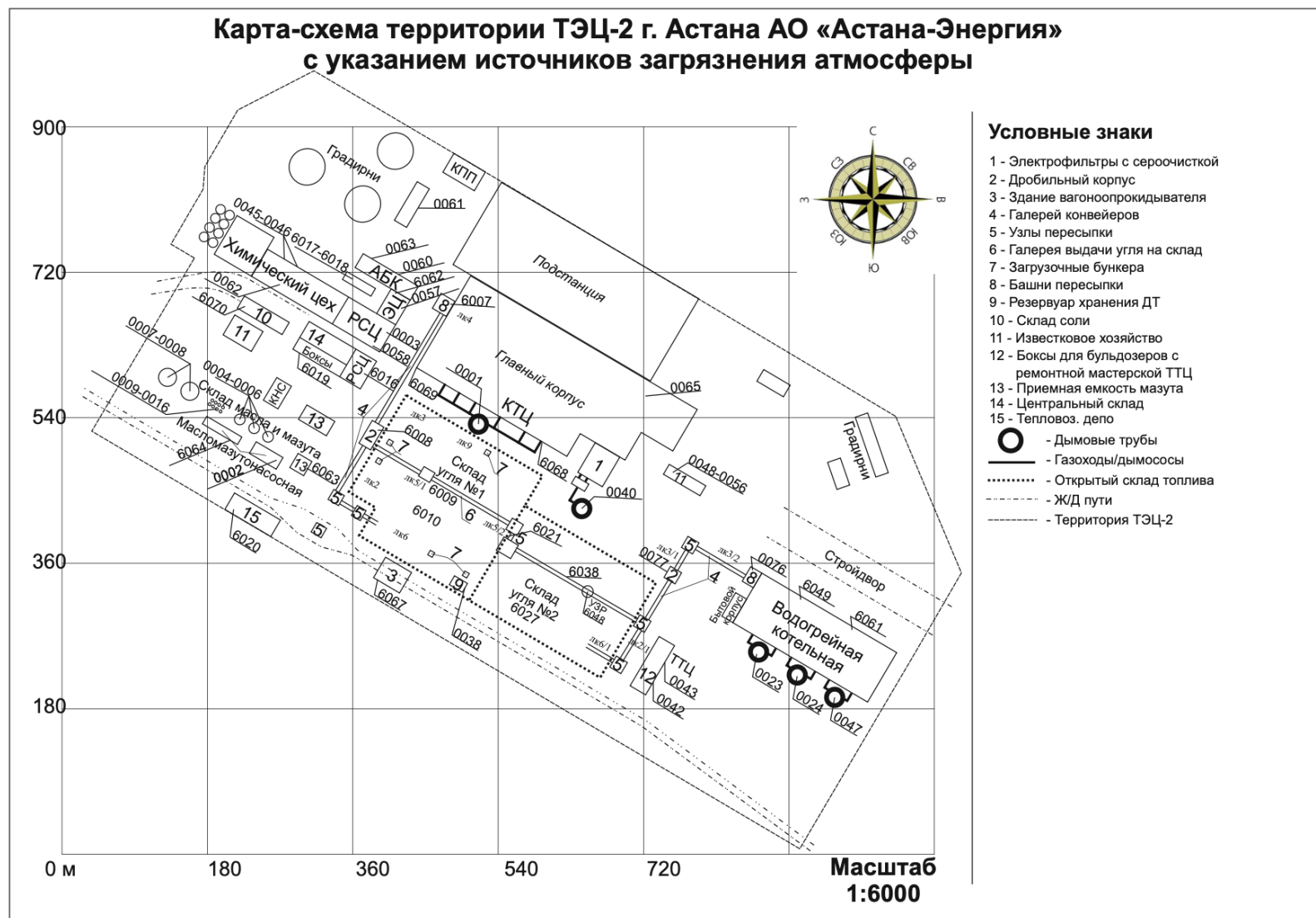
Рисунок 2 Карта-схема предприятия с нанесенными на нее источниками выбросов загрязняющих веществ в атмосферу
