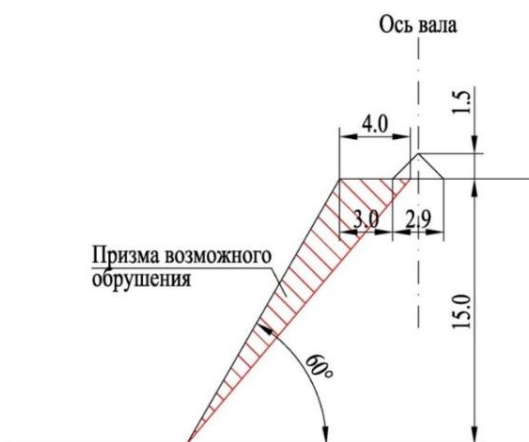
Рисунок 3.1 – Призма возможного обрушения
