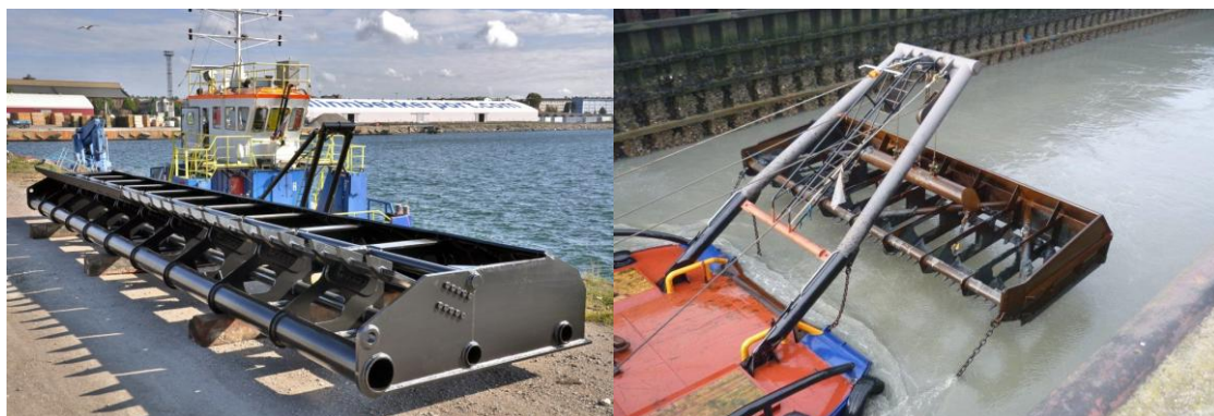
Рисунок 7.5 Плуг (слева) и плуг, подвешенный на раме на корме буксирного судна (справа)
