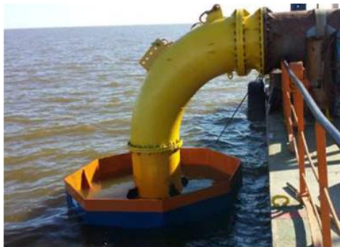
Рисунок 7.8 Надводные изображения Cooking Pot (Варочного котла)®, применяемого в Северном Каспии
