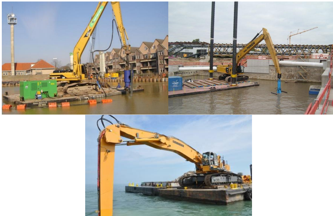
Рисунок 7.4 Механический земснаряд (МЗ) снизу, оснащенный ПЗС (слева) или грейферным ковшом (справа)
