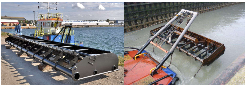
Рисунок 5.4 Плуг (слева) и плуг, подвешенный на раме на корме буксирного судна (справа)
