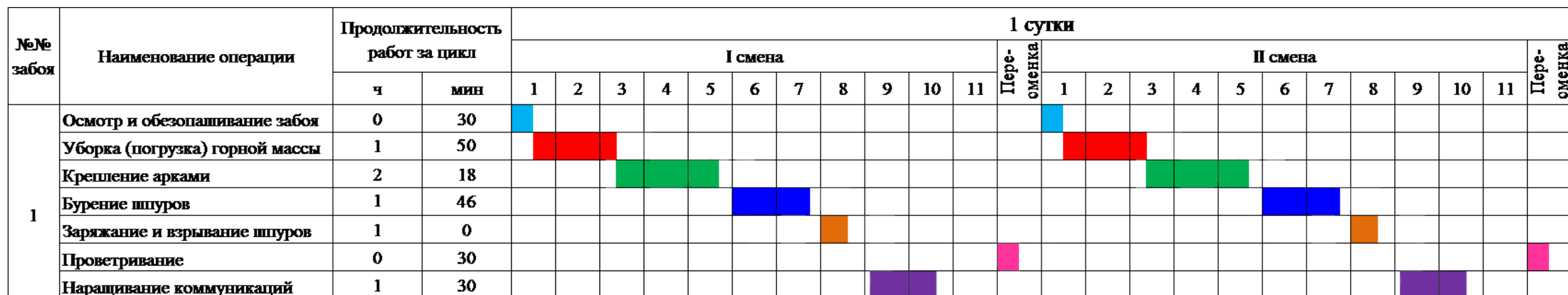
Рисунок 4.5.3.4.2 – Циклограмма выполнения горнопроходческих работ в рыхлых породах
