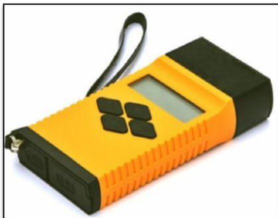
Рис. 5-4-4в Портативный измеритель магнитной восприимчивости КТ КМ-7
