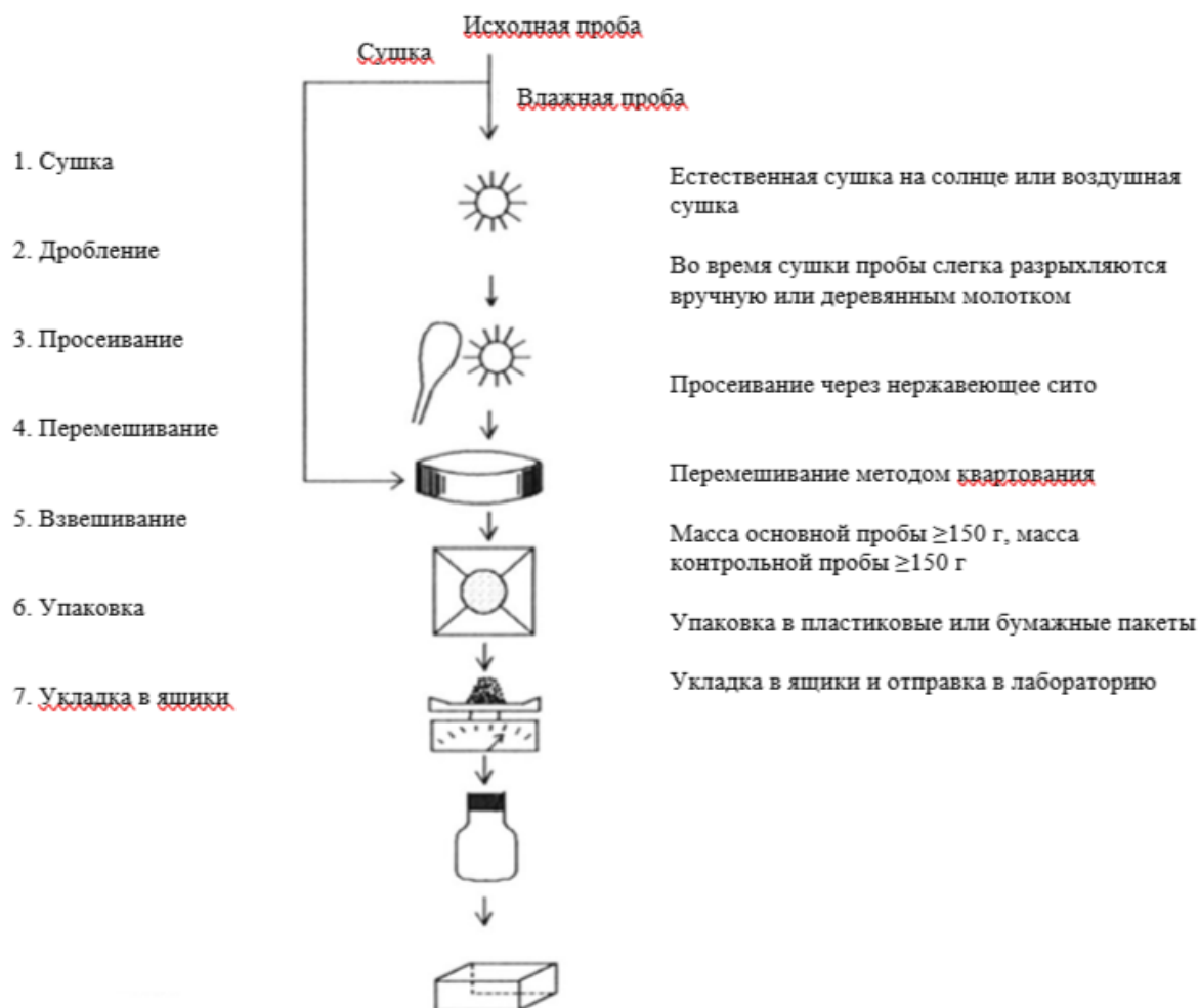
рисунк 5-4-5 Схема технологического процесса обработки полевых проб
