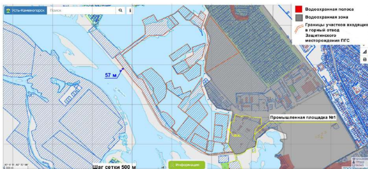
Рисунок 8 – Границы водоохранных зон и полос реки Иртыш вблизи рассматриваемого объекта
