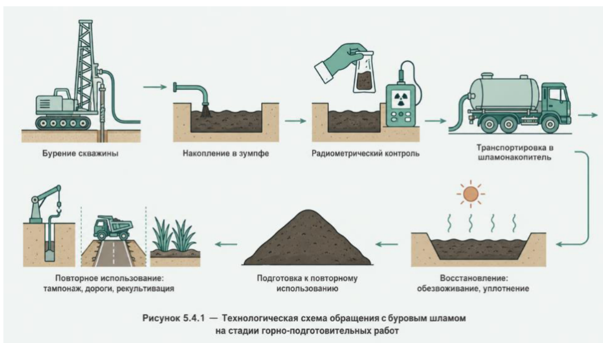
Рисунок 5.4.1 — Технологическая схема обращения с буровым шламом на стадии горно-подготовительных работ
