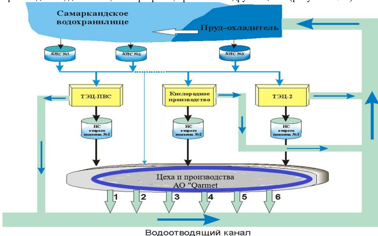
Рисунок 2.5-1 – Общая схема водопотребления и водоотведения АО «Qarmet»
