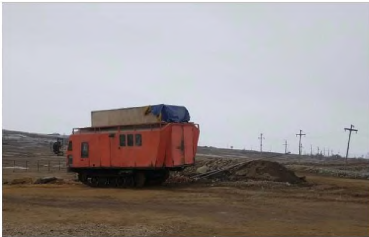
Рисунок 14. Фотография самоходной буровой установки LF-90 подрядчика.
