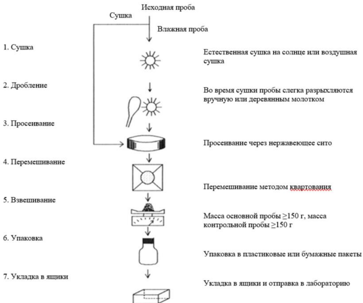
Рисунок 5-4-3 Схема технологического процесса обработки полевых проб
