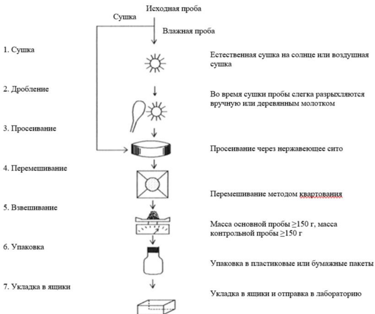
Рисунок 5-4-3 Схема технологического процесса обработки полевых проб
