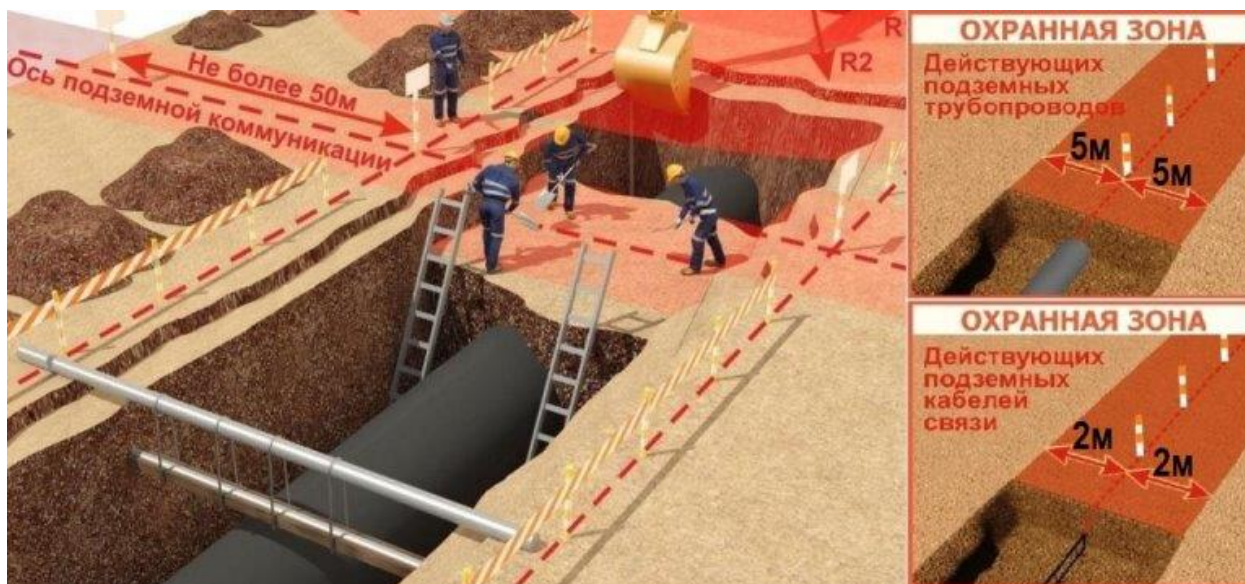
Рис.8 Вскрытие действующих коммуникации, пересекающих проектируемый трубопровод
