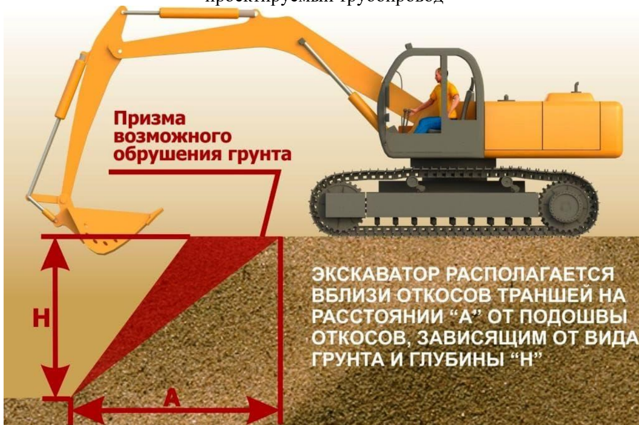
Рис.9 Установка и работа экскаватора вблизи траншеи
