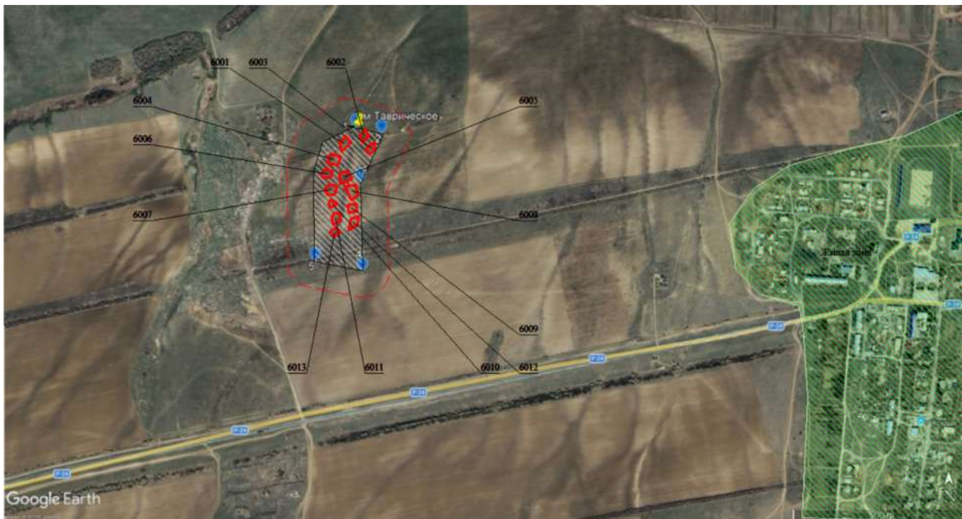
Рисунок 1.1 – Карта-схема района расположения Таврического месторождения кирпичных суглинков с указанием границ санитарно-защитной зоны, источников выбросов загрязняющих веществ в атмосферный воздух и ближайшей жилой застройки
