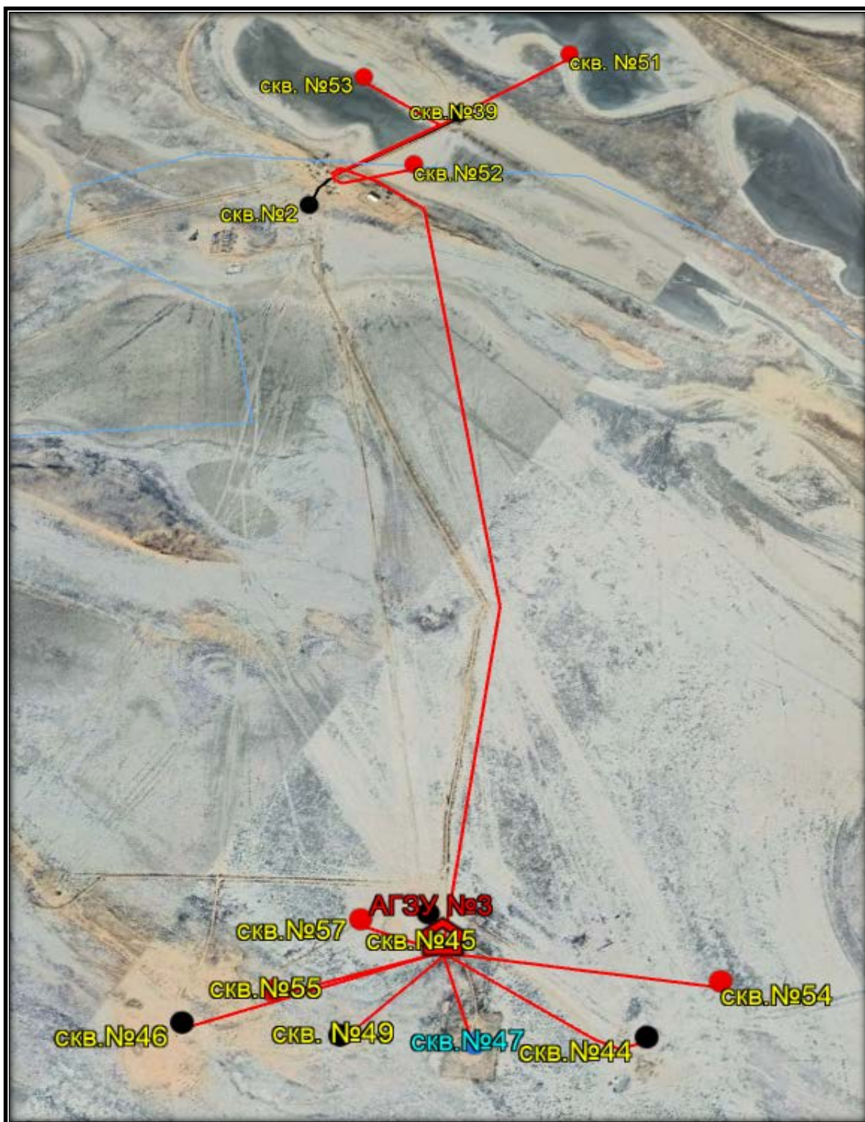
Рис. 6.3.4. Схема подключения новых скважин к АГЗУ №2 на месторождении «Сазтобе С.В.»
