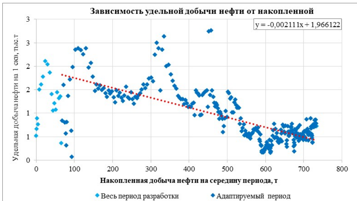
Рис. 3.2.13 – Зависимость удельной годовой добычи нефти от суммарных отборов по месторождению Сазтобе Юго-Восточное
