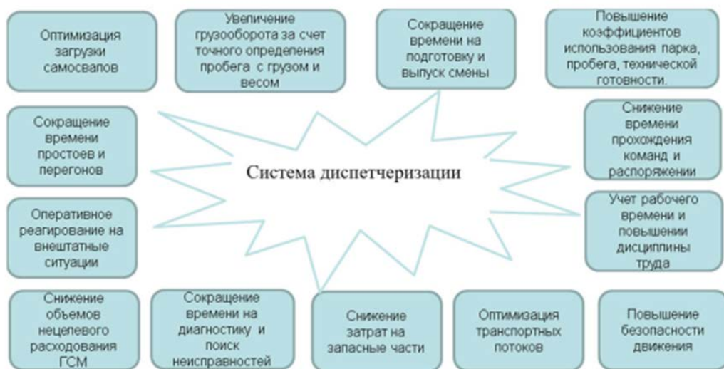
Рис. 5.36. Структура и функции системы диспетчеризации
