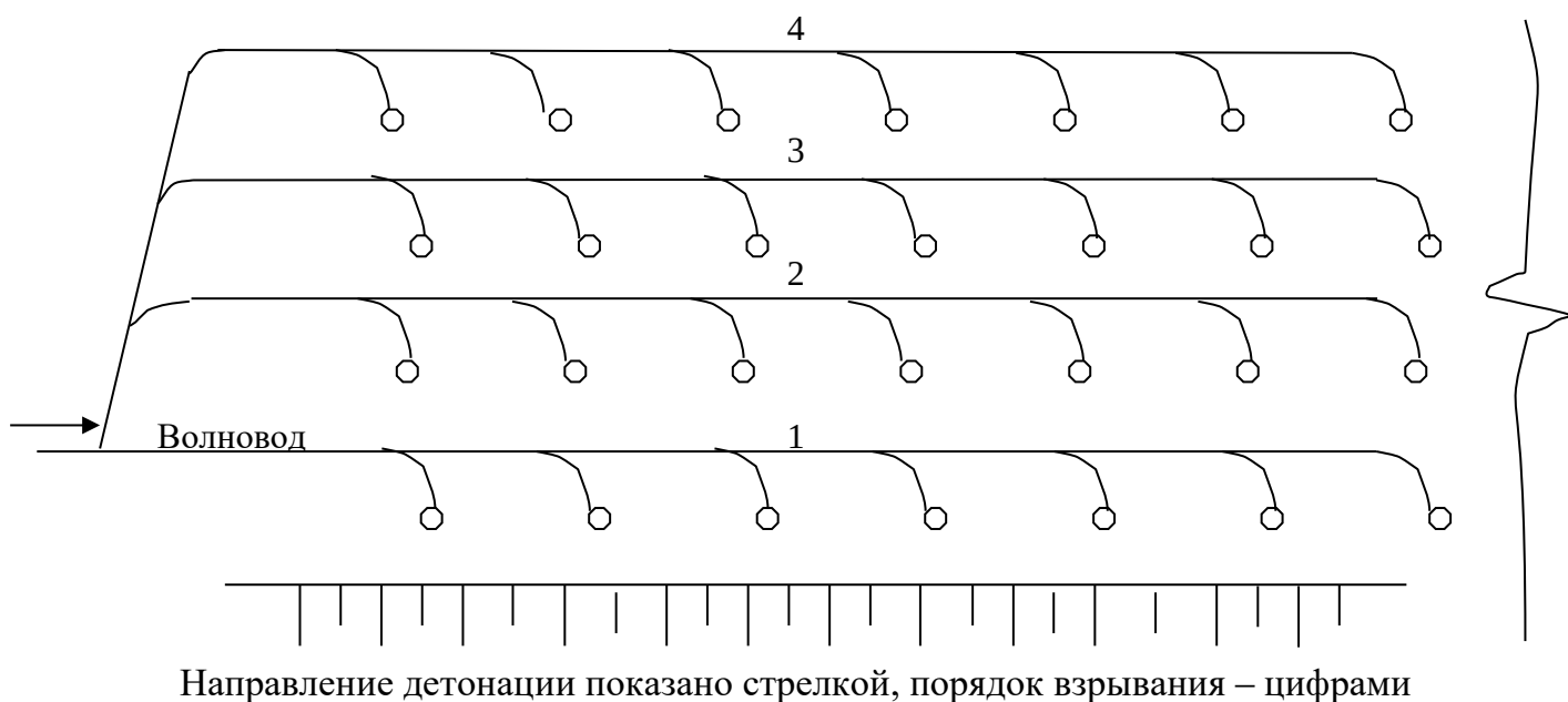
Рис. 5.13- Схема взрывной сети
