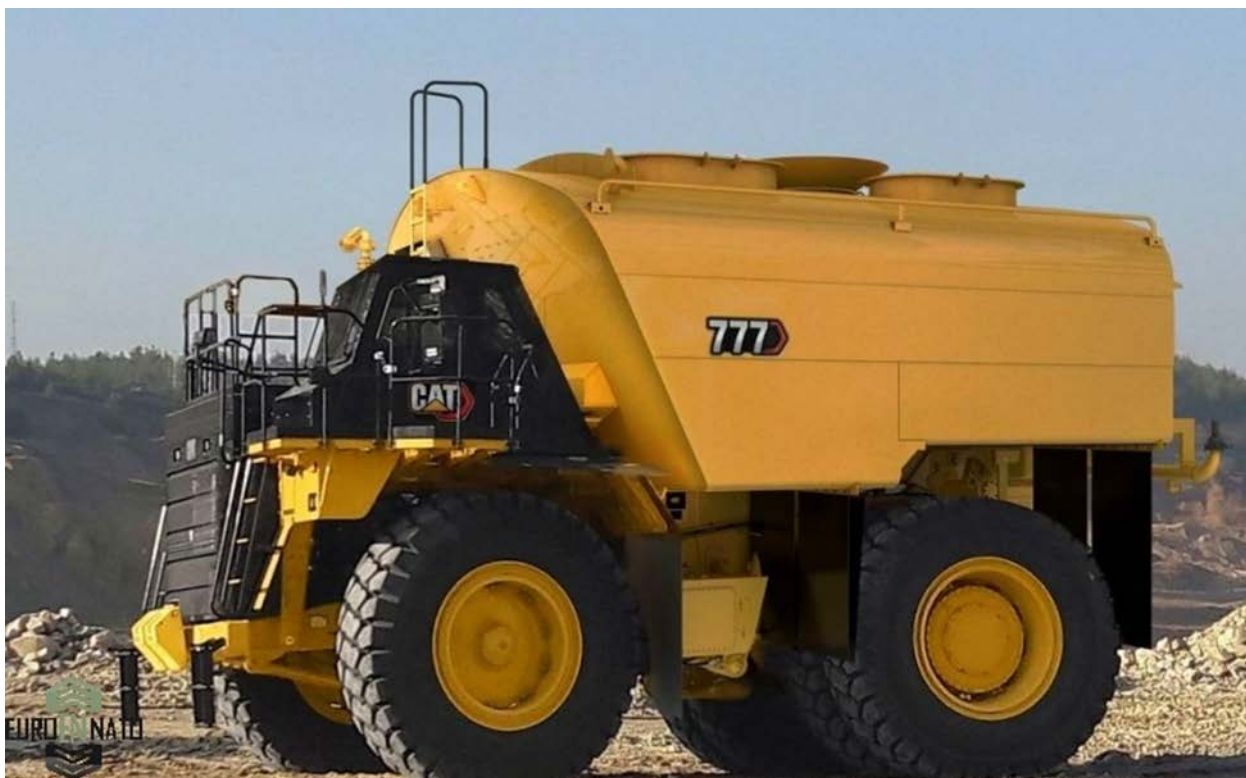
Рисунок 5.25 – Общий вид поливооросительной машины CAT-777D
