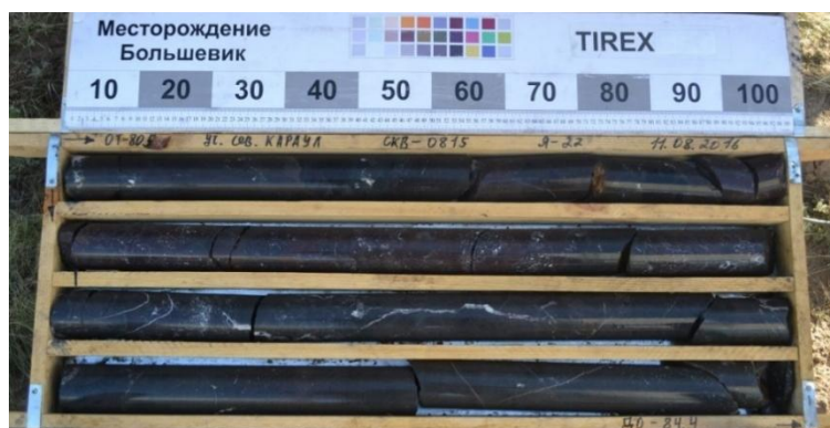
Рис. 4.5.1.2 Пример линейки и цветной/черно-белой контрольной полосы, для корректировки цветового баланса при фотографировании керна
