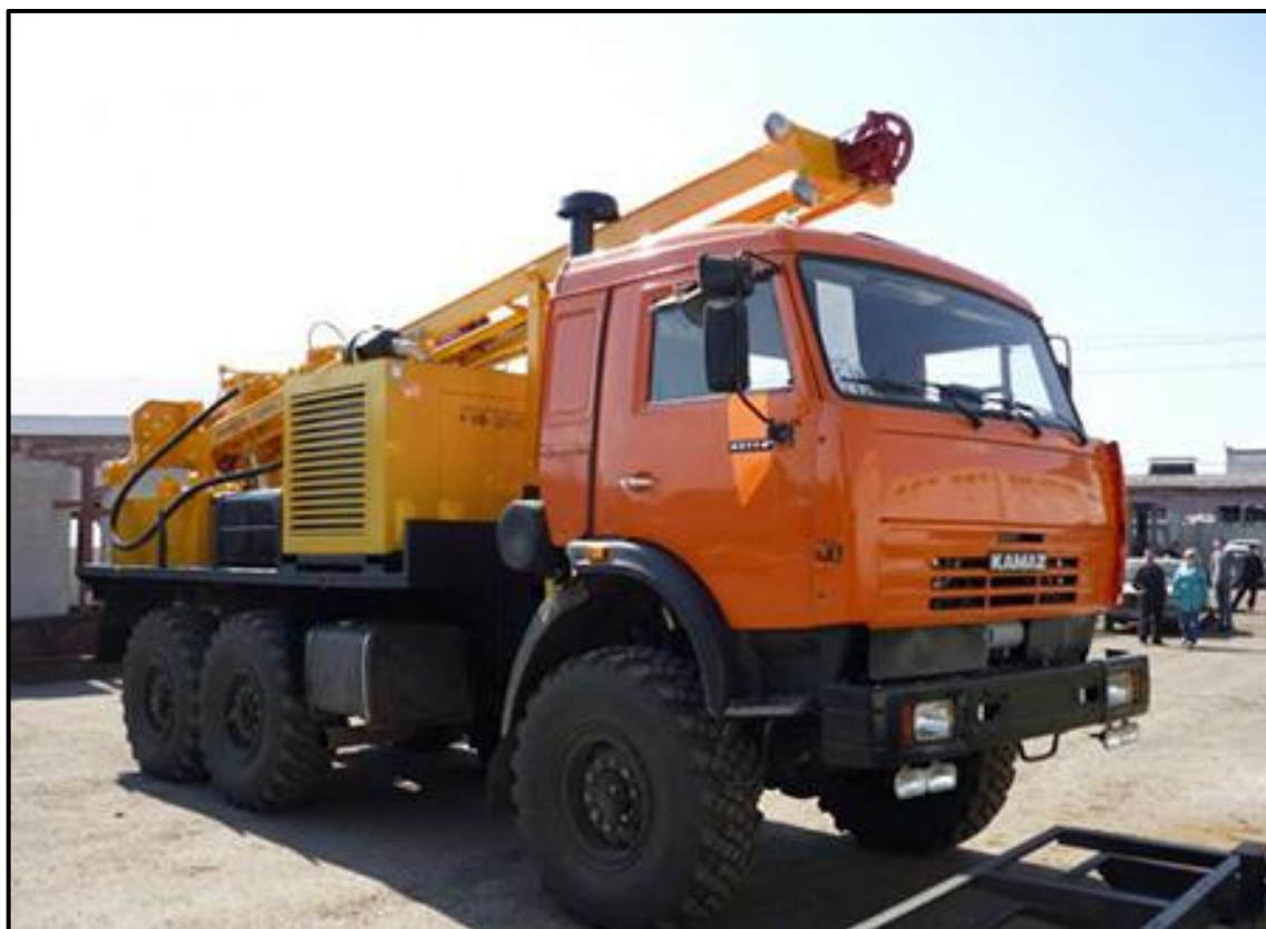
Рисунок 5.6 Буровая установка УРБ-2А2
