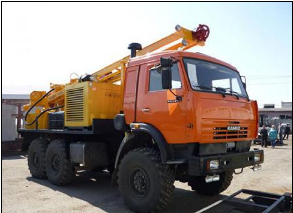
Рисунок 5.6 Буровая установка УРБ-2А2
