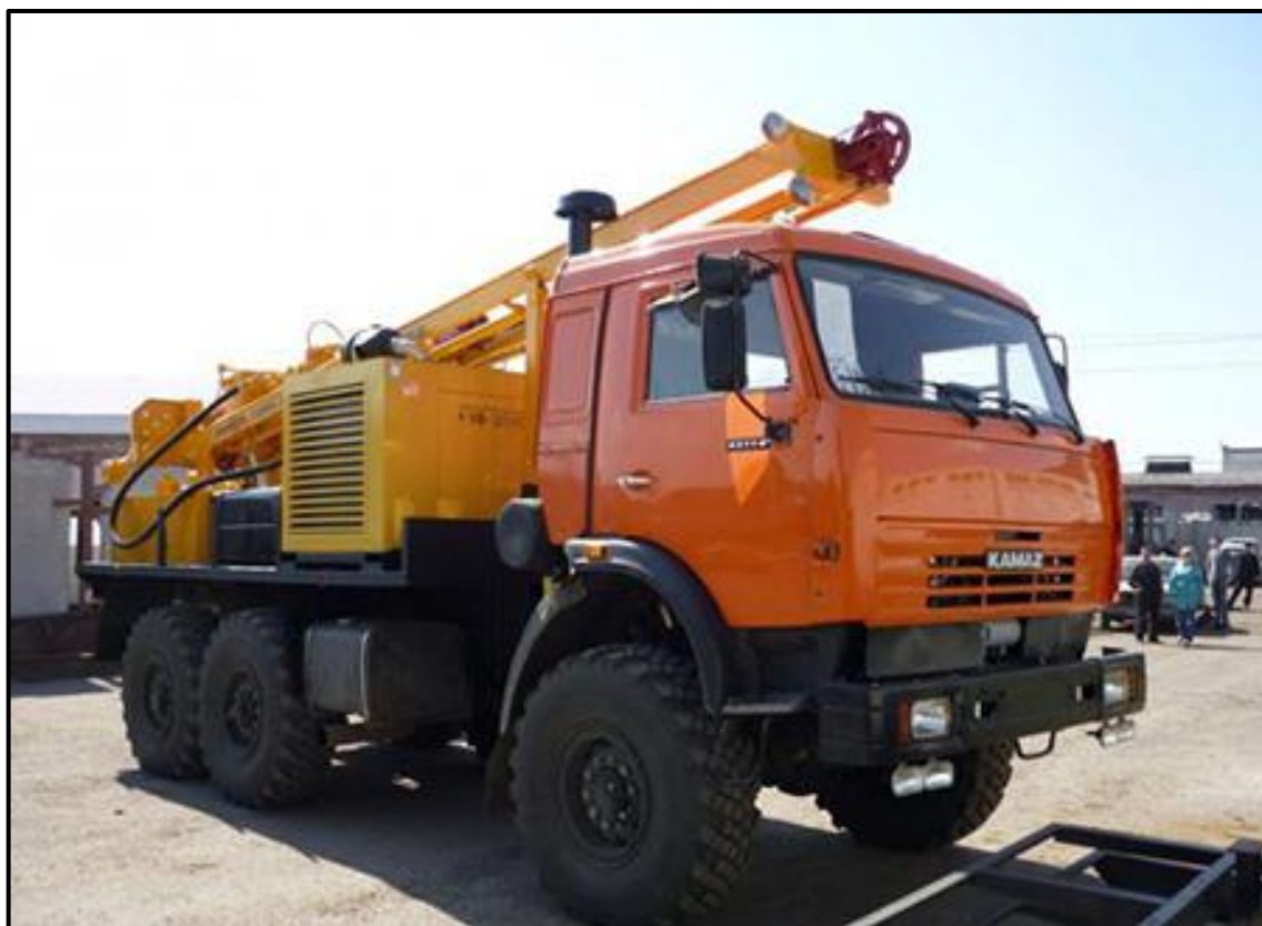
Рисунок 5.6 Буровая установка УРБ-2А2
