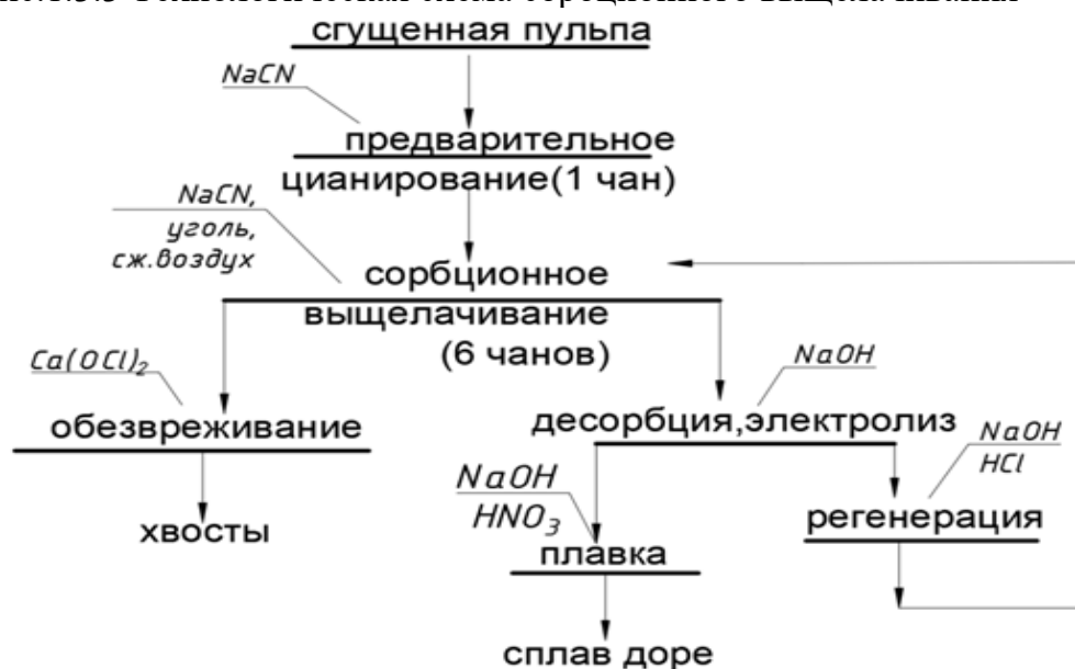
Рис.1.3.3 Технологическая схема сорбционного выщелачивания
