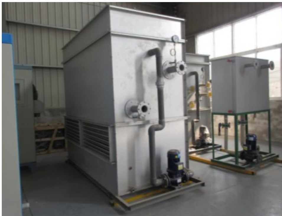
Рис.3. Закрытая система охлаждения.
