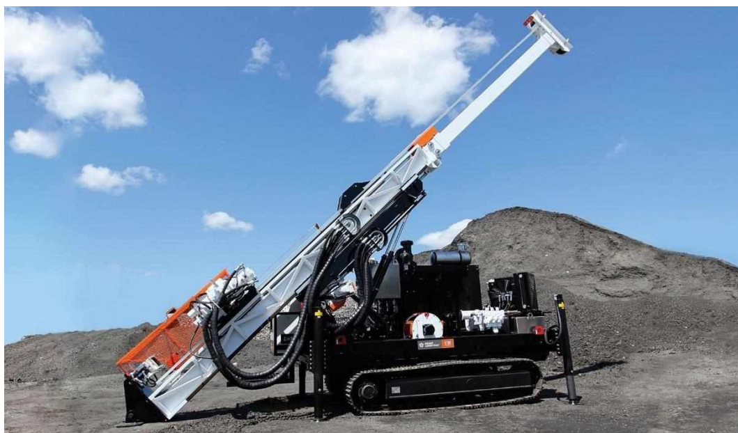
Рисунок4—Буровая установка LF-90
