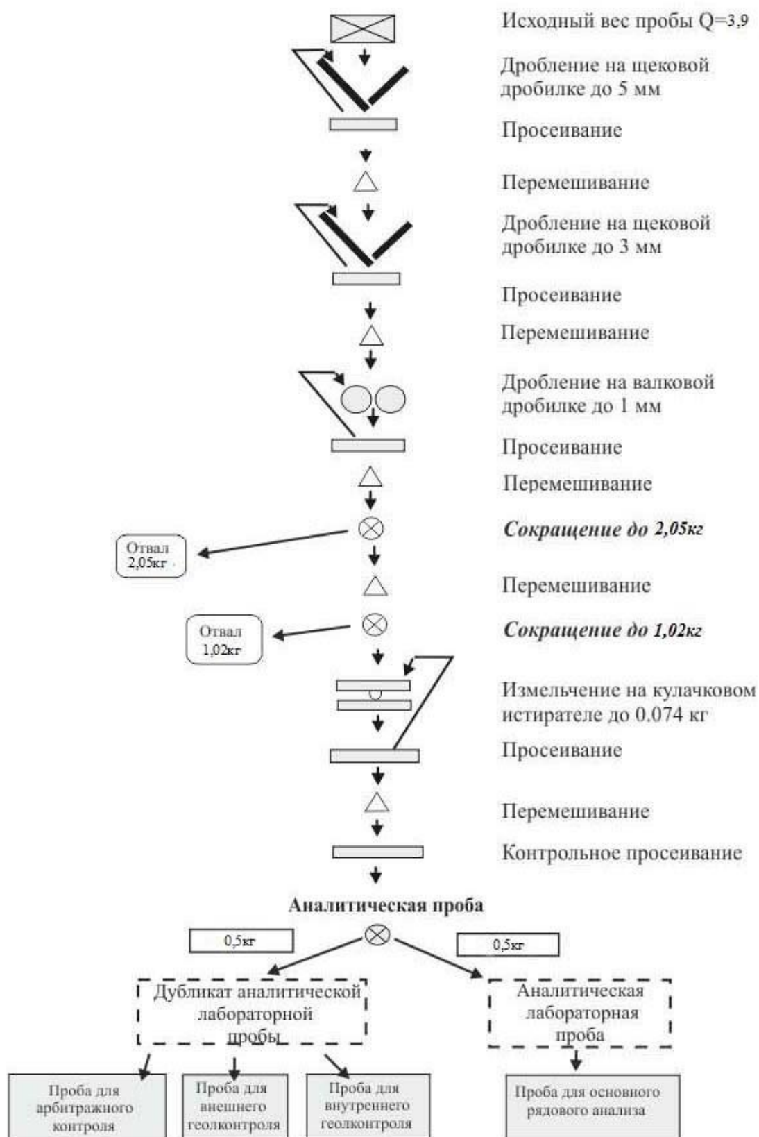
Рис. 4.1 Схема обработки бороздовых и керновых проб
