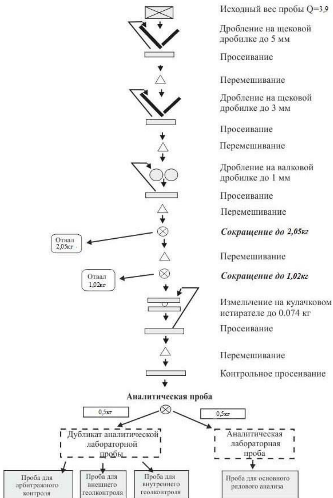
Рис. 4.1 Схема обработки бороздовых и керновых проб
