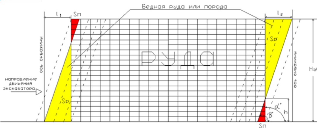
Рисунок 3.5.1 - Схема к расчёту нормативов потерь и разубоживания в приконтактных зонах при разработке крутопадающих залежей
