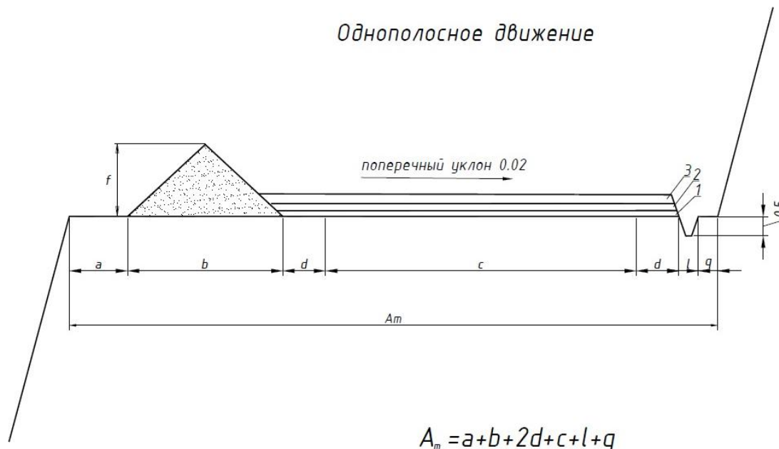
Рис. 3. Расчет ширины транспортного съезда
