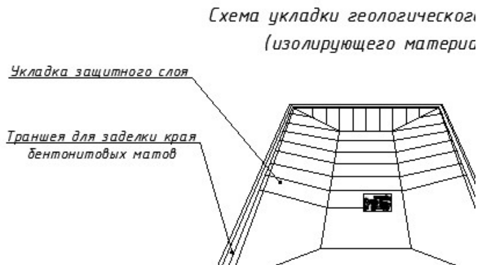
Рисунок 4.1 – Схема укладки бентонитовых матов
