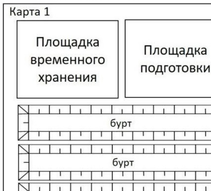
Рисунок 8 – Схема размещения площадок и буртов для размещения компостируемой массы
