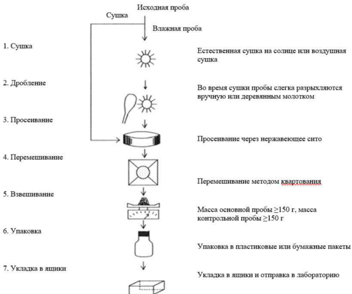
Рисунок 5-4-2 Схема технологического процесса обработки полевых проб
