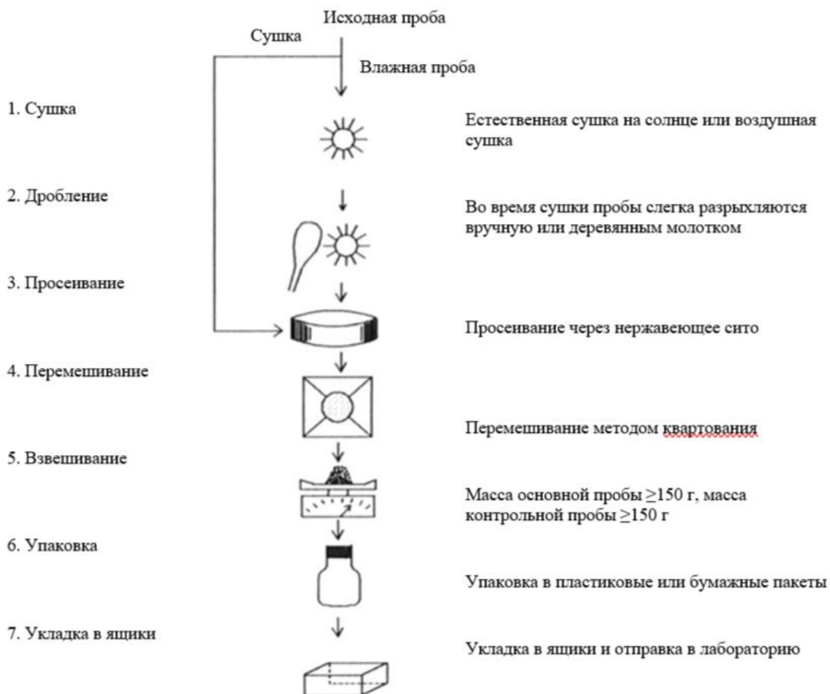
Рисунок 5-4-2 Схема технологического процесса обработки полевых проб
