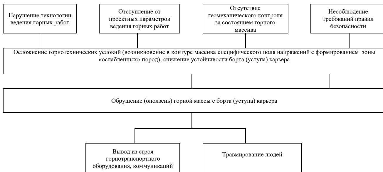
Рисунок 17 - Блок-схема вероятного сценария аварии при обрушении (оползней) горной массы с борта (уступа) карьера
