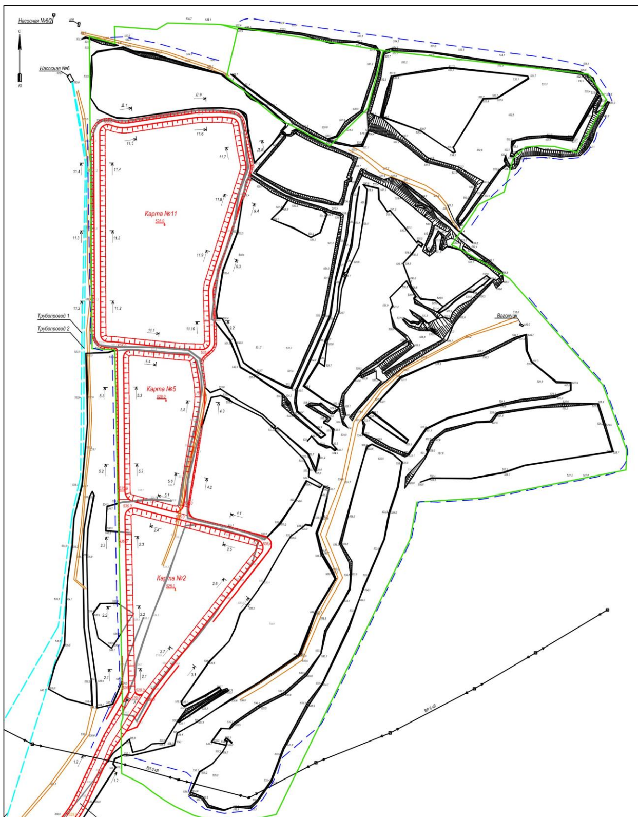
Рис. 2.13 Положение шламоотстойника после проведения работ первого этапа реконструкции
