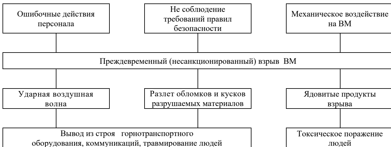
Рисунок 8.2 - Блок-схема вероятного сценария аварии при преждевременном (несанкционированном) взрыве ВВ при проведении взрыва в блоке с механизированным заряджанием скважин
