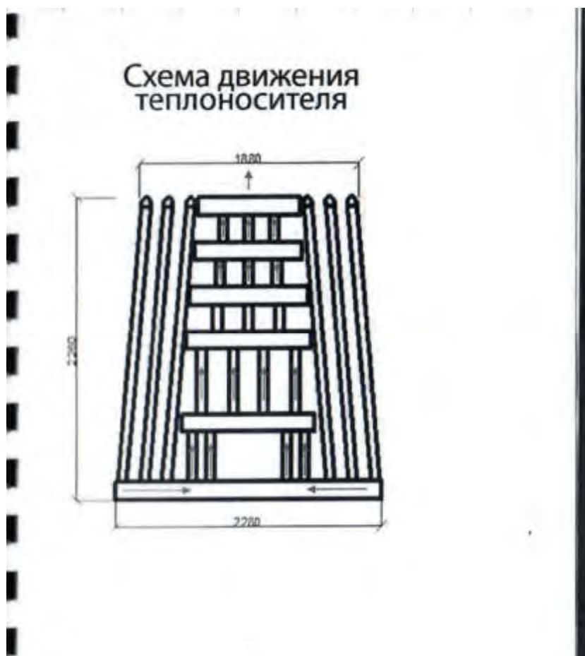
Рисунок 2.1 – Схема движения теплоносителя в котле КВр-1,0КБ
