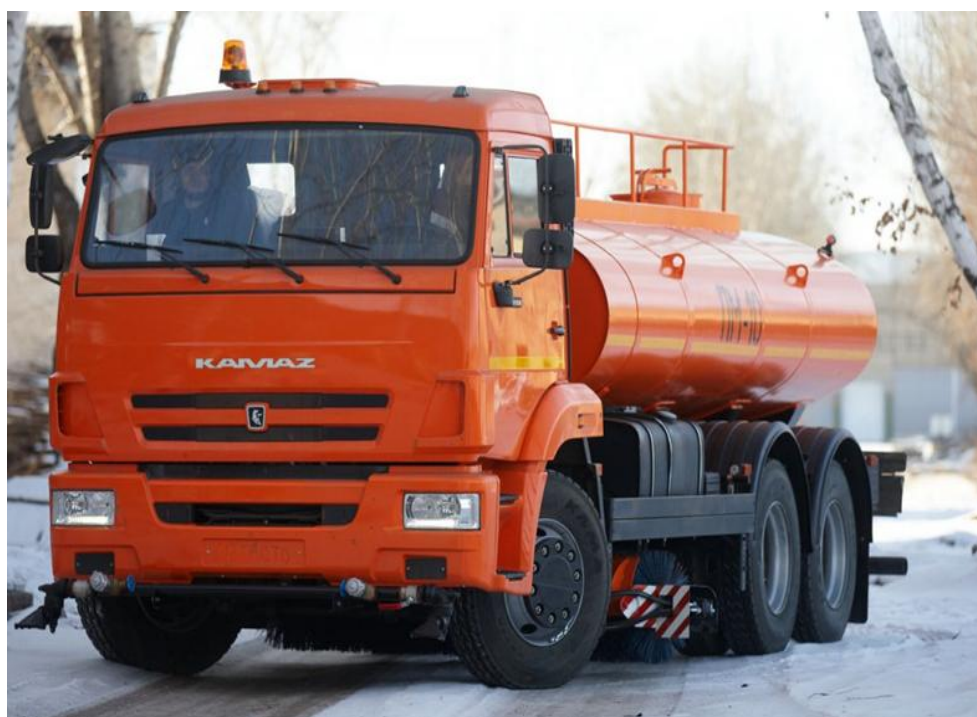
Рис. 11. Водополивочная машина на базе КАМАЗ-65115
