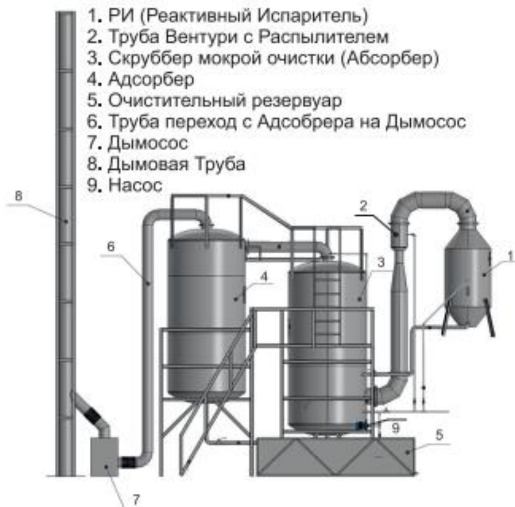
Рисунок 2. Схема мокрого фильтра МФ-001-У
