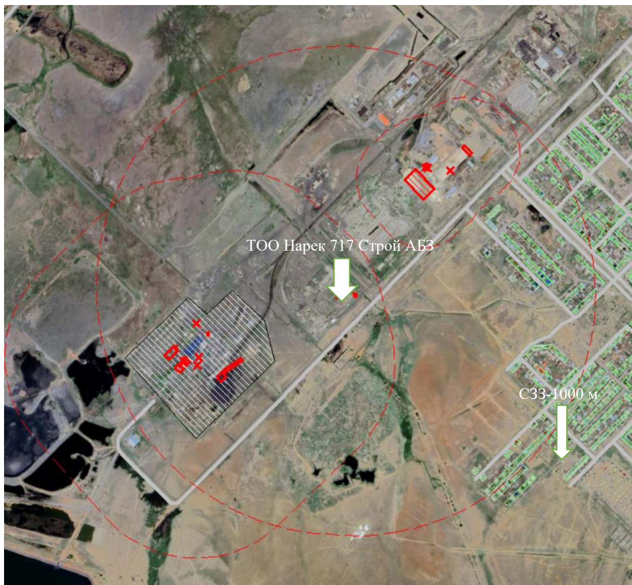
Рисунок 9.3 – Спутниковый снимок промплощадки ТОО Нарек 717 Строй АБЗ с установленной санитарно-защитной зоной в 1000 м
