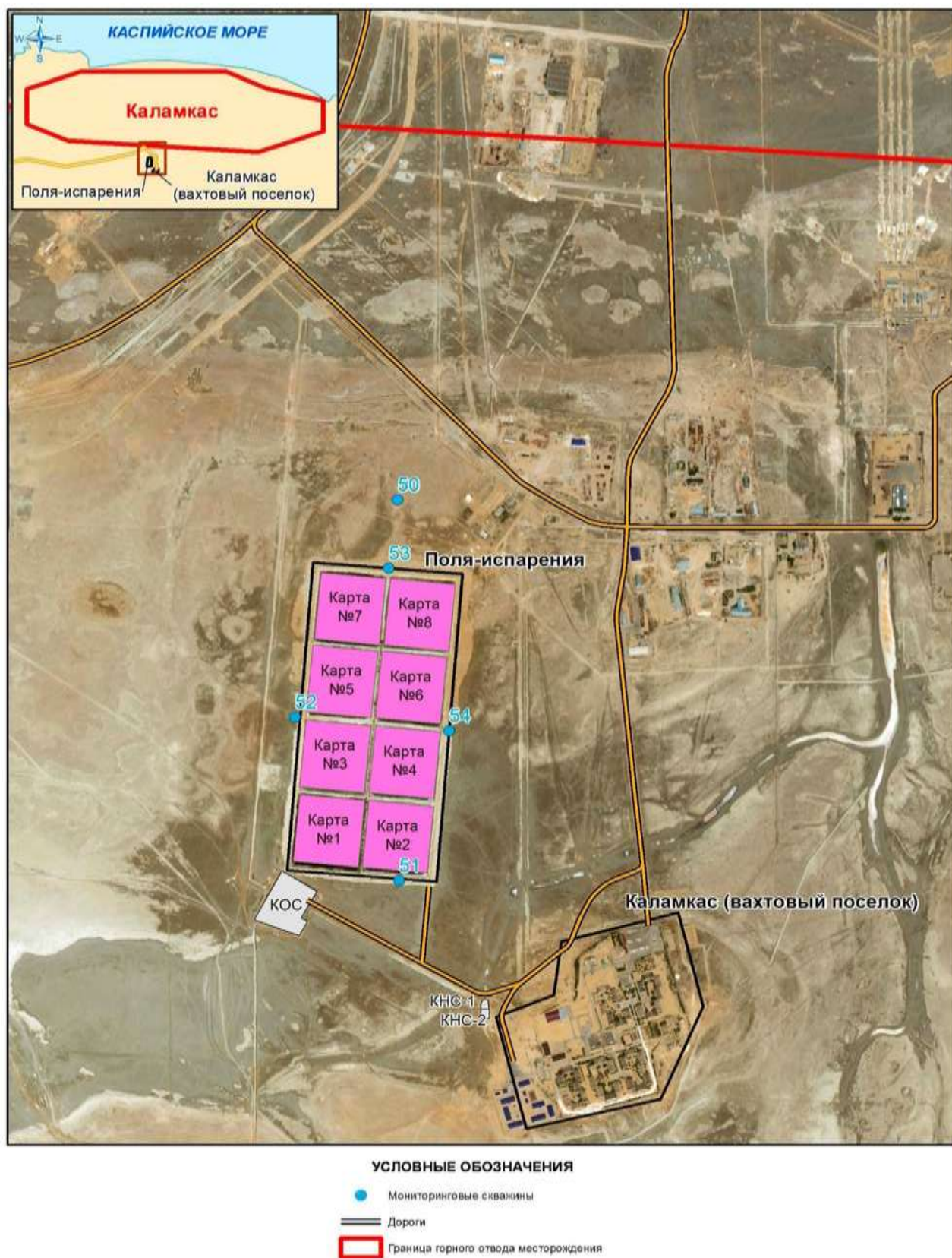
Рисунок 14 - Карта-схема расположения мониторинговых скважин в районе полей-испарения на месторождении Каламкас
