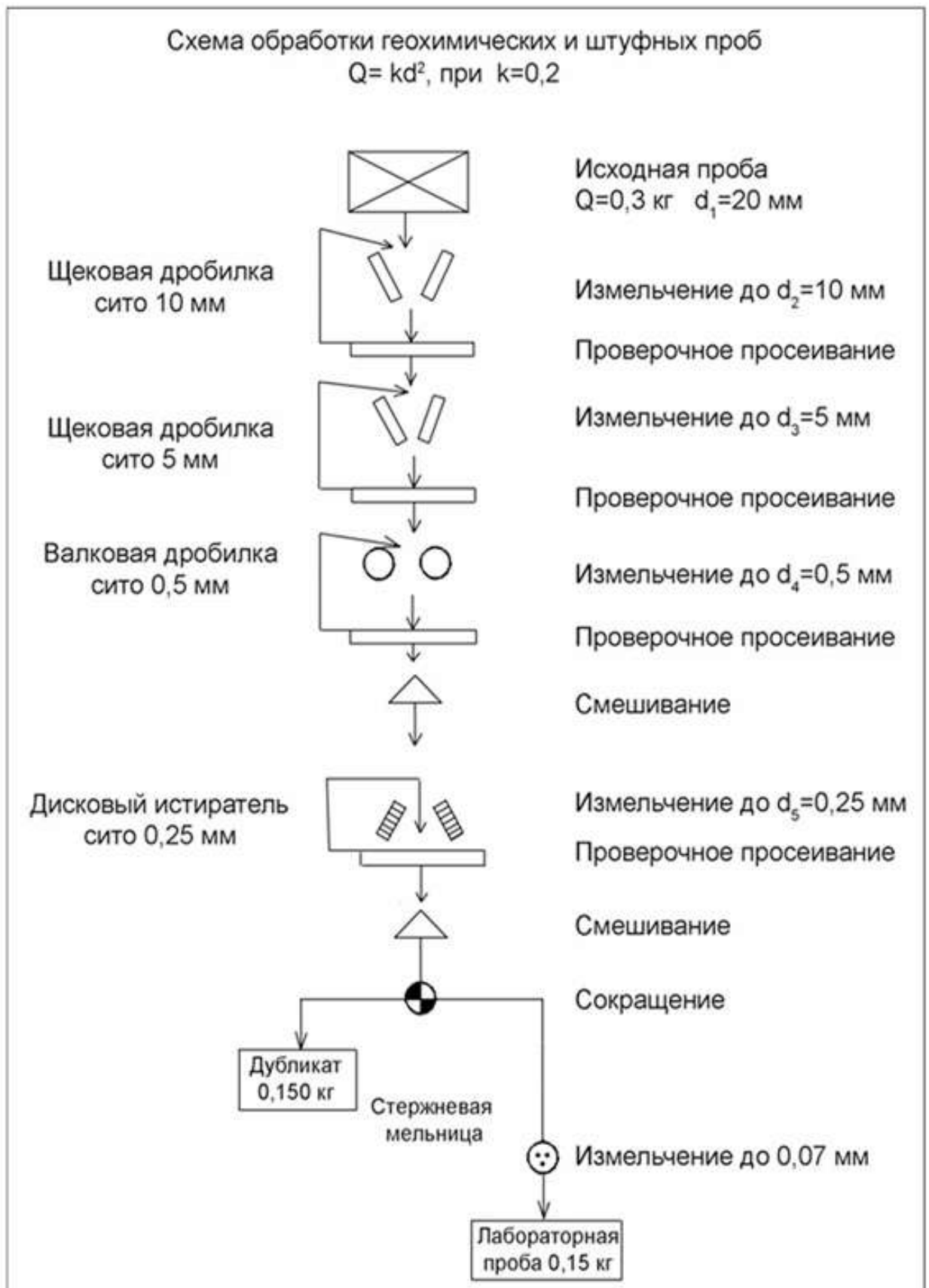
Рис. 7 Схема обработки штучных проб
